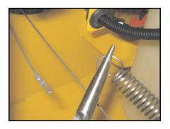
**DISCONNECT CABLE TENSION SPRING** (PART#37527)
