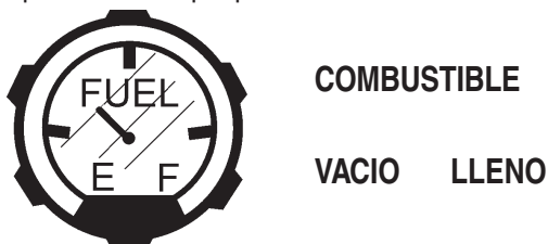
Figura 11. Medidor de combustible
