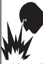
L'ajout de carburant au réservoir devrait être fait seulement lorsque le moteur est arrêté et a eu du temps pour se refroidir. Au cas où il ya a un déversement de carburant, **N'essayez PAS** de démarrer le moteur tant que le résidu de carburant n'ait pas été complètement essuyé et que la zone avoisinante du moteur ne soit sèche.
