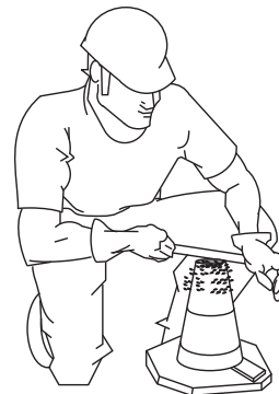
Figura 44-D. Prueba de asentamiento (Remover el exceso de concreto)
