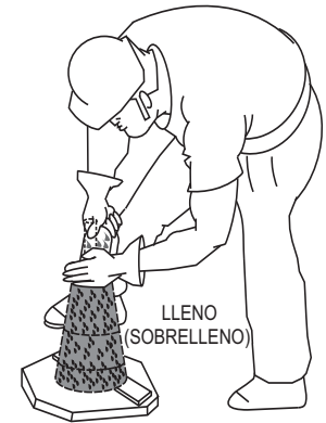
Figura 44-C. Prueba de asentamiento (Lleno completamente)
