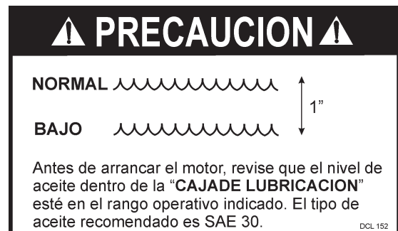
Figura 16. Calcomanía de precaución del nivel de aceite de la caja de lubricación
