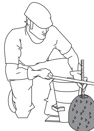
Figura 44-E. Prueba de asentamiento (Cono invertido)
