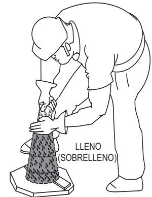
Figura 32-C. Prueba de asentamiento (Lleno completamente)
