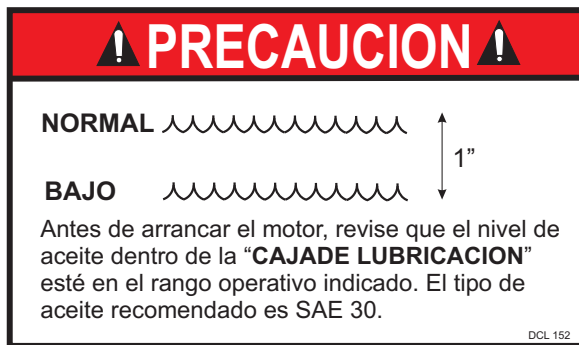
Figura 17. Calcomanía de precación del nivel de aceite de la caja de lubricación
