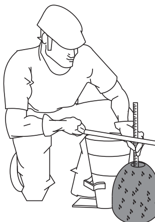
Figura 32-E. Prueba de asentamiento (Cono invertido)
