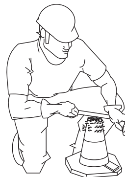
Figura 32-D. Prueba de asentamiento (Remover el exceso de concreto)
