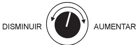
**Figura 47. Perilla de control de ajuste de voltaje**
