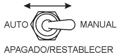
Figura 42. Interruptor de control MPEC (Posición manual)
