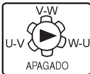
Figura 18. Interruptor de inversión del amperímetro CA
