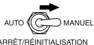
Figure 41. Commutateur de commande MPEC (Position manuelle)
