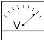
Figure 14. AC Voltmeter
