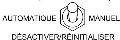
**Figure 40. Commutateur Convertisseur MPEC**
