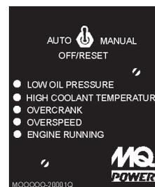
Si le moteur ne s'enclenche pas (démarrer) à la troisième tentative, le **Mode Protection D'emballement** de la commande coupe le moteur. Si le moteur démarre à une vitesse (TPM) risquée, la commande coupe le moteur en initialisant le **Mode Protection de Survitesse**.
