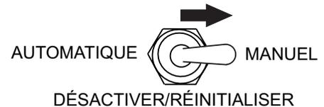
Figure 28. Commutateur de Commande MPEC (Position Manuelle)
