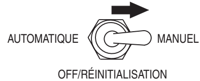
Figure 26. Commutateur de commande MPEC (position manuelle)
