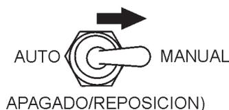
**Figura 42. Interruptor de Control MPEC (Posición Manual)**
