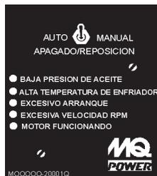
Si el motor no enciende en el tercer intento el motor es parado por el controlador de **protección de excesivo arranque**. Si el motor enciende a una velocidad (RPM's) que no es segura, el controlador de **protección de velocidad excesiva** apagará el motor.
