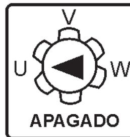
Figure 1. Interruptor Amperímetro CA de Inversión
