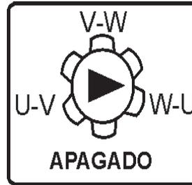
Figura 17. Interruptor Voltímetro CA de Inversión
