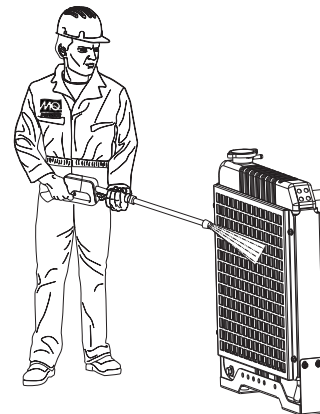
Figure 73. Nettoyage des radiateurs
