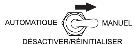
Figure 28. Commutateur de Commande MPEC (Position Manuelle)
