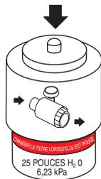
Figure 52. Indicateur de restriction du filtre à air
