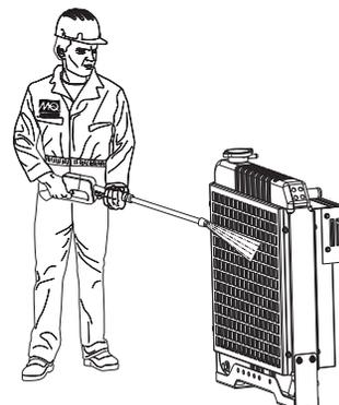
**Figure 60. Nettoyage du radiateur**
