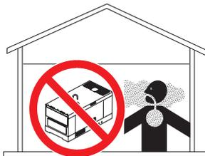
■ Lorsque vous utilisez le générateur à l'extérieur, **NE PAS** placer le générateur à proximité de portes, de fenêtres ou d'évents qui pourraient permettre au monoxyde de carbone de pénétrer et de s'accumuler dans les espaces occupés.
