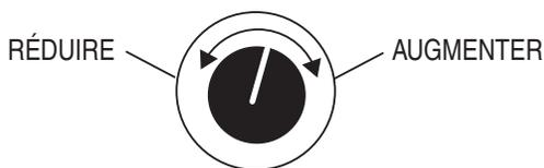
Figure 45. Bouton de commande du régulateur de tension
