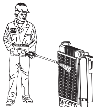
Figure 70. Nettoyage des radiateurs
