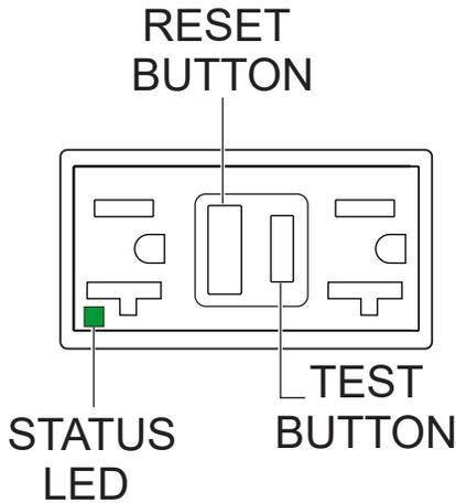
Figure 7. 120-Volt GFCI Receptacle
