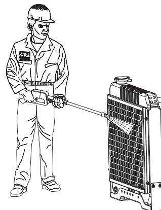
Figure 73. Nettoyage des radiateurs
