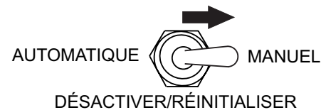
Figure 28. Commutateur de Commande MPEC (Position Manuelle)
