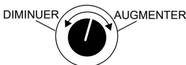
**Figure 19. Bouton de régulateur de tension 1Ø-120 VAC Vérification de la tension de sortie**
