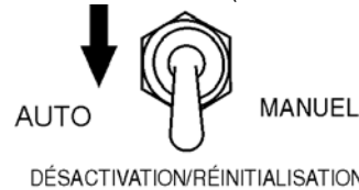
Figure 55. Commutateur de commande MPEC (désactiver/réinitialiser)
