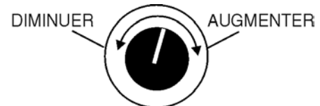
Figure 9. Bouton de commande du régulateur de tension
