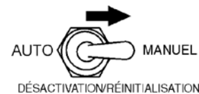
Figure 40. Commutateur de commande MPEC (position manuelle)
