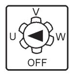
Figure 20. AC Ammeter **Change-Over Switch**
