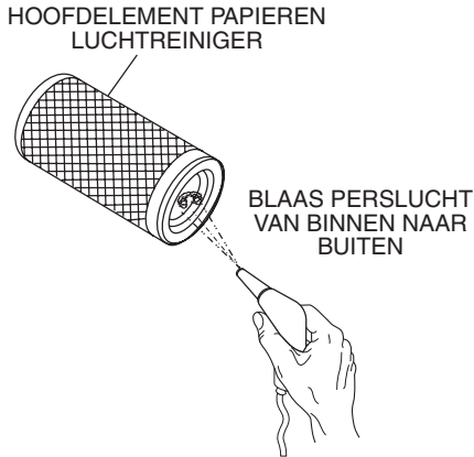
Afbeelding 20. Papieren luchtfilterelement reinigen
