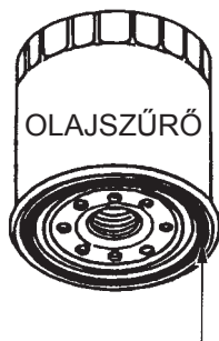
TÖMÍTÉS 23. ábra Olajsűrő/tömítés
