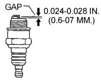
Figure 28. Spark Plug Gap
