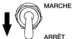
**Schéma 21. Commutateur de fonctionnement (Arrêt)**
