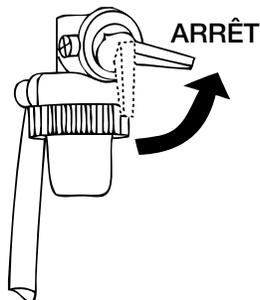
**Schéma 22. Levier de robinet à essence du moteur (Arrêt)**
