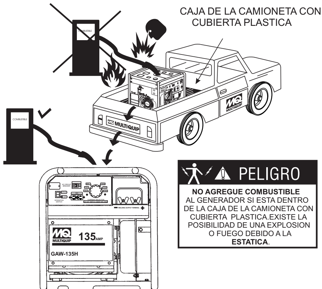
Figura 3. Reabastecimiento de combustible del generador/soldadora
