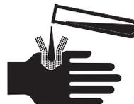
Batteriefüllsäure enthält korrodierende, toxische Chemikalien (verdünnte Schwefelsäure). Kontakt mit Augen und Haut vermeiden.
