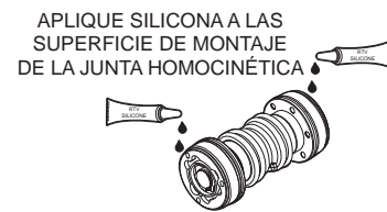
Figura 21. Aplicación de silicona RTV
