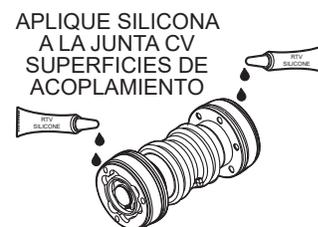
**Figura 17. Aplicación de silicona RTV**
