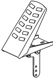
**Figura 16. Pedal del control de la velocidad de la llana**
