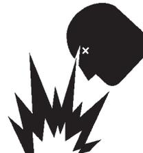
■ **NUNCA fume** en los alrededores ó cerca de la máquina. Puede ocasionar un incendio o explosión de los **vapores del combustible**, ó si el combustible se derrama sobre el motor **caliente**.
