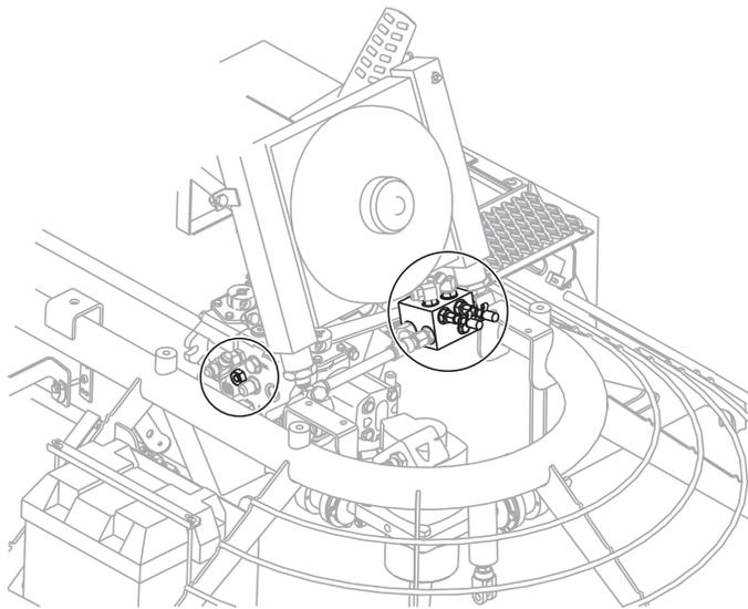
Figura 42. Acopladores para revisar la presión
