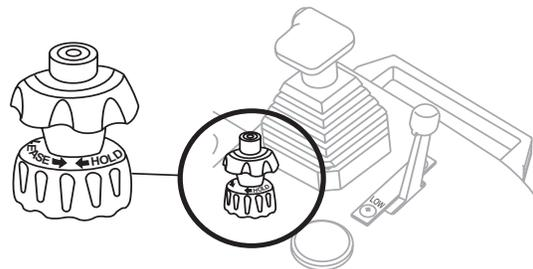
**Figura 19. Control del limitador de velocidad**
