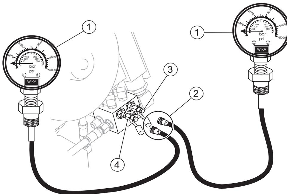
1. Medidor de presión - 5,000 PSI de rango
