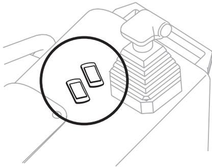
**Figura 30. Interruptores oscilantes para el ajuste de la llana**
