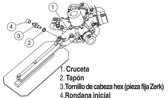
**Figura 34. Retirando la pieza fija de la grasera Zerk**
