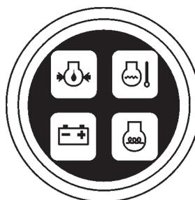
**Figura 12. Luces indicadores del aceite y carga**
