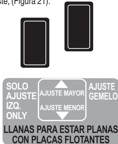
Figure 21. Interruptores oscilantes para ajuste de la llana
