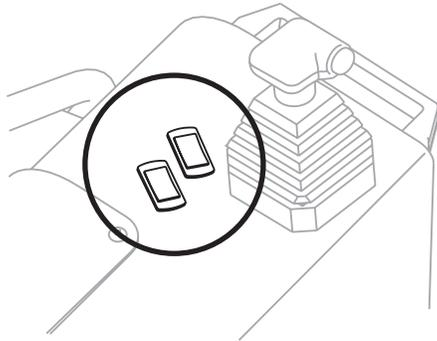
Figura 20. Control del ajuste de las llanas
