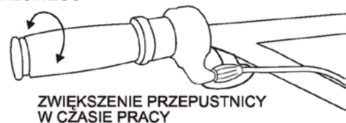
Rys. 23. Przepustnica (Pozycja obrotów jałowych)
