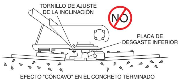
**Figura 50. Alineación incorrecta de la placa de la cruceta**
