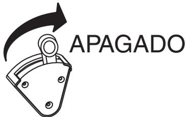
**Figura 34. Interruptor de parada de seguridad (OFF)**
