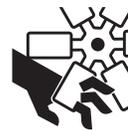
**NUNCA** coloque las manos o los pies dentro de los anillos de protección mientras el motor está funcionando. **SIEMPRE** apague el motor antes de efectuar cualquier mantenimiento a la allanadora.
