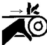
**UNTER KEINEN UMSTÄNDEN** dürfen Sie die Maschine bei abgenommenen Schutzabdeckungen oder -vorrichtungen betreiben. Halten Sie Finger, Hände, Haare und Kleidung von jeglichen beweglichen Teilen fern, um Verletzungen zu vermeiden.
