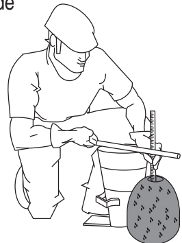
Figura 69-F. Prueba de asentamiento (Midiendo)
