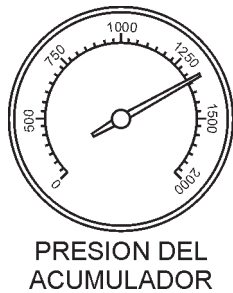
Figura 30. Medidor de presión del acumulador
