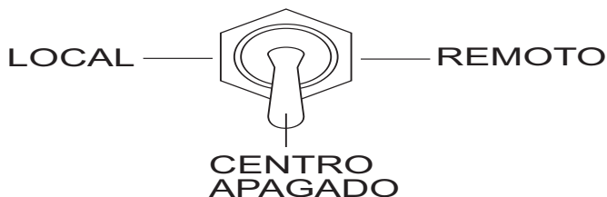
Figura 21. Interruptor de control de bombeo (OFF APAGADO)
