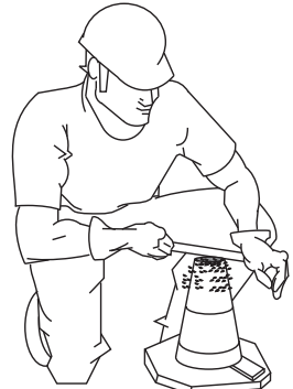
Figura 69-D. Prueba de asentamiento (Remover el exceso de concreto)
