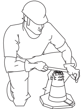
Figura 68-D. Prueba de asentamiento (Remover el exceso de concreto)
