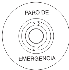
Figura 19. Interruptor de paro de emergencia
