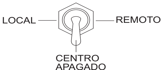
Figura 21. Interruptor de control de bombeo (OFF APAGADO)
