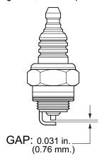
Figure 27. Spark Plug Gap
