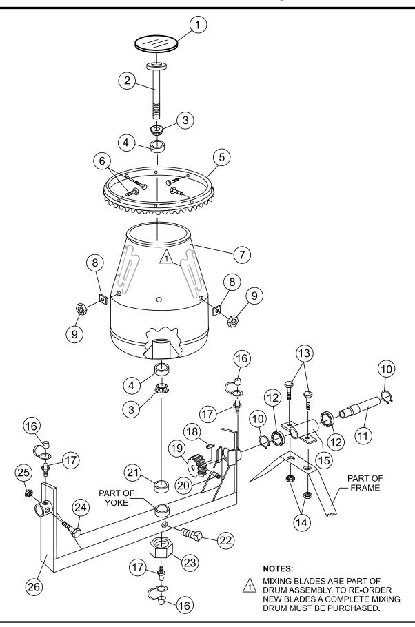
PAGE 10 — MC94SK/PK CONCRETE MIXER • PARTS MANUAL — REV. #0 (09/26/22)
