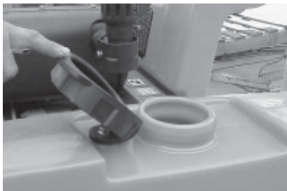
Figura 10. Revisando el tanque de agua
