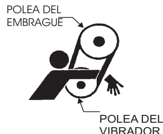
Figura 26. Peligros con la banda-V
