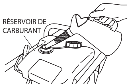
Figure 4. Réservoir de carburant
