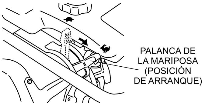
**Figura 9. Palanca de la mariposa (posición de arranque)**
