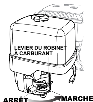
Figure 11. Levier de la soupape de carburant du moteur (position ON)
