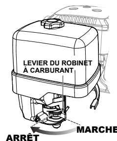
Figure 20. Levier de la soupape de carburant (OFF)
