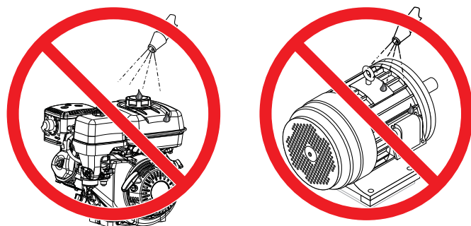
Figure 37. Pas de pulvérisation d'eau
