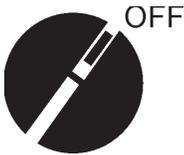
**STETS** den Motorschalter auf **OFF** (AUS) stellen, wenn der Fugenschneider nicht verwendet wird.
