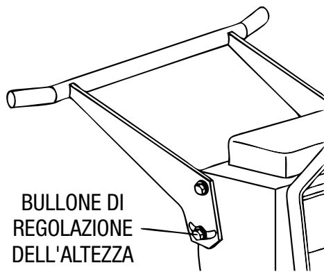
Figura 19. Bulloni di regolazione dei manici
