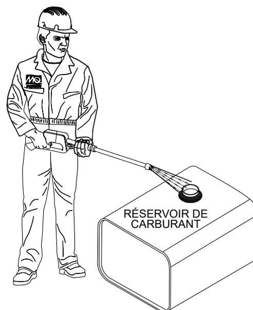
Figure 49. Nettoyage du réservoir de carburant
