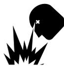
Gas infiammabile, esplosivo. (produce gas idrogeno mentre si ricarica o durante il funzionamento). Tenere l'area attorno alla batteria bene areata e tenere lontano da fonti ignifughe.
