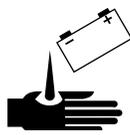
L'elettrolita della batteria contiene sostanze chimiche corrosive e tossiche (acido solforico diluito). Evitare il contatto con gli occhi e la pelle.
