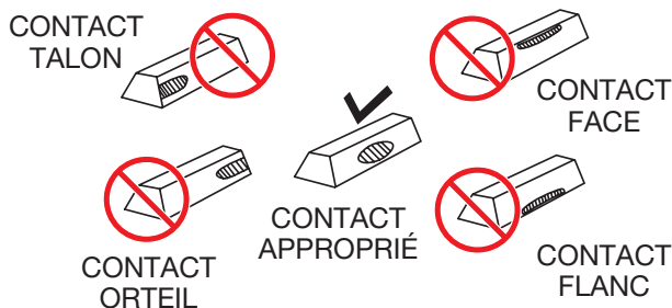
Figure 24. Alignement des dents de l'engrenage
