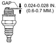
Figure 21. Spark Plug Gap
